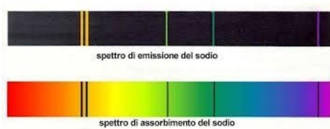
Se ne deduce che tutte le sostanze assorbono radiazioni luminose della stessa frequenza e lunghezza d'onda di quelle che sono in grado di emettere. E' quello dell'assorbimento il principio su cui si basa la spettroscopia stellare, in quanto i raggi di luce provenienti dalla fotosfera delle stelle, devono attraversare gli strati più esterni e più freddi, dando luogo allo spettro di assorbimento.
